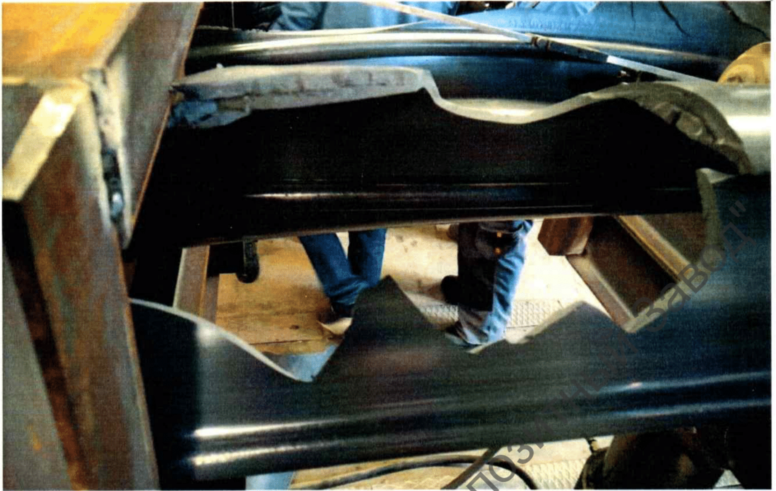
Рисунок 7. Средняя часть образца после испытания
